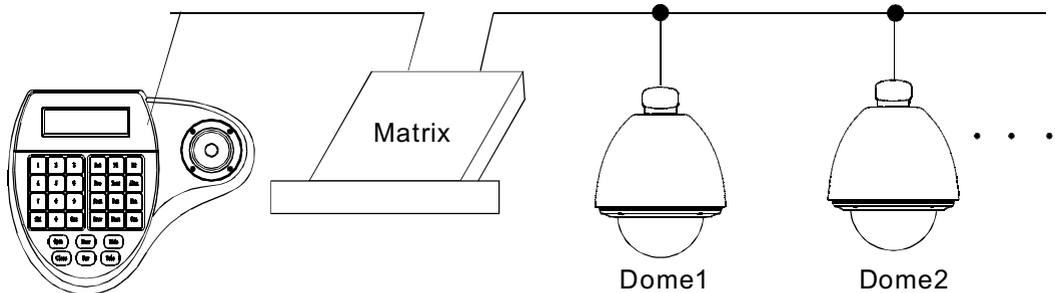
Bis zu vier KB1000 Einheiten können gleichzeitig in einem System verwendet werden. Die ID's der KB1000 Einheiten müssen dabei unterschiedlich sein.
